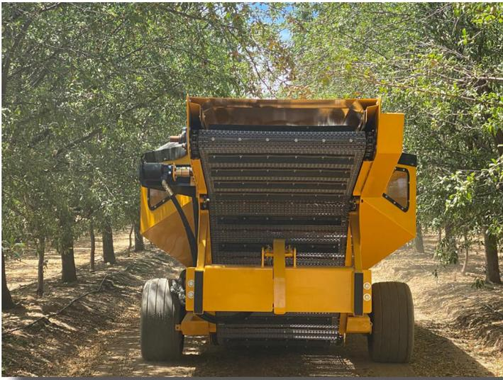
Con 9,91 m<sup>3</sup> de capacidad, un sistema de entrega de cadena doble con un ancho de transportador de 1066 mm, sinfines de nivelación doble y una formación cónica elegante que maximiza el volumen interno mientras mantiene las dimensiones generales tan bajas como sea posible.
